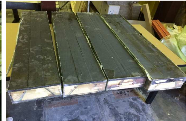
Resin infusion System (VARTM Technique)
